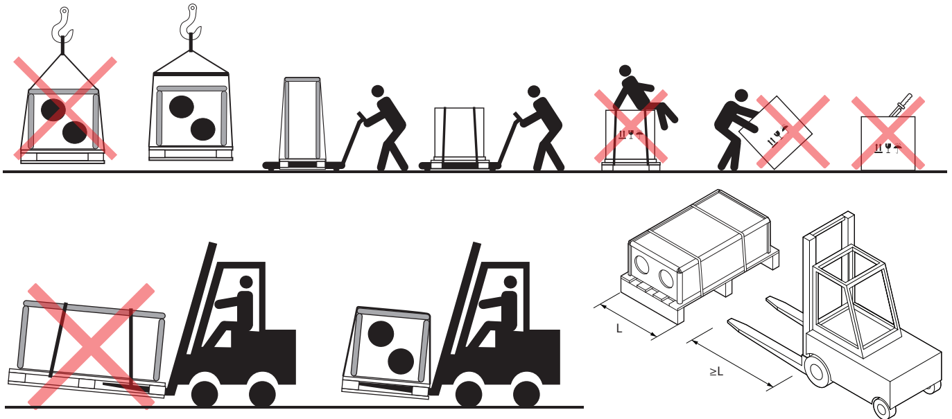
Joonis 4. Näiteid kraana, kahveltõstuki ja käruga transportimise kohta
